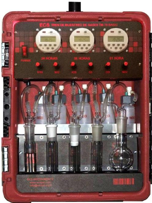
Sistema manual diseñado para el muestreo de gases ambientales por el método de la adsorción química
