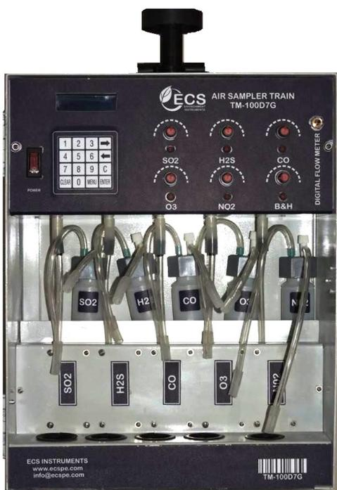
Sistema manual diseñado para el muestreo de gases ambientales por el método de la adsorción química
