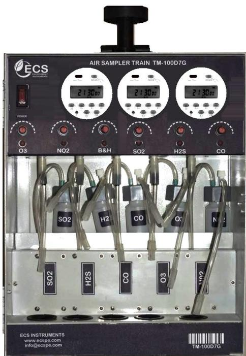
Sistema manual diseñado para el muestreo de gases ambientales por el método de la adsorción química
