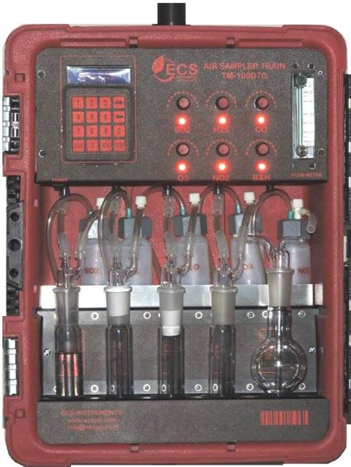
Sistema manual diseñado para el muestreo de gases ambientales por el método de la absorción química
